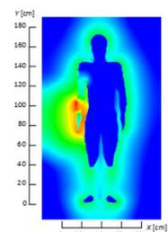
図3 人体通信時の電磁界分布
