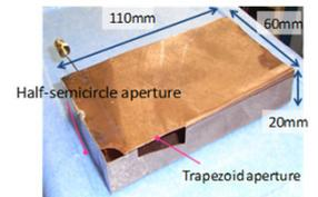
図2 金属筐体開口を利用した電子機器組み込みアンテナ
